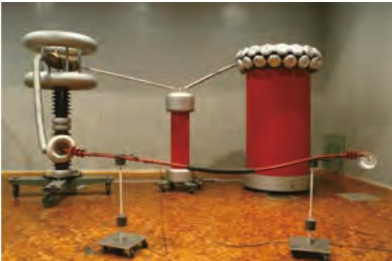
工频试验变压器
