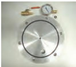
压力测试板配备O型圈，安装在测试板的密封槽内，以密封环氧树脂母模件。通过调节阀门可将六氟化硫SF<sub>6</sub>气体充入母模件内部，监视气体压力表计来确定是否达到正确压力7bar (0.7MPa)。
