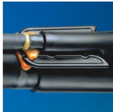
在接头部分电缆的外护套被内部涂有热密封胶的厚壁绝缘热缩管代替。在加热时热熔胶开始熔化并流动有效地起到防潮和抗腐蚀的作用。接地线部分通过带有热熔密封胶的分歧夹密封。
