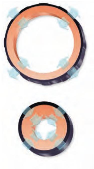
两根双层热缩套管是接头的核心零件。由于采用了独特的弹性橡胶技术，这些双层套管能够迅速收缩并形成厚度均匀的绝缘层。每根双层共挤套管的外层为热缩材料，内层为与外层交联的硅橡胶材料并在外层的牵拉作用下保持扩张状态。当对外层加热时，外层套管将向预定直径收缩，内层套管也同时收缩并紧套在电缆上。
